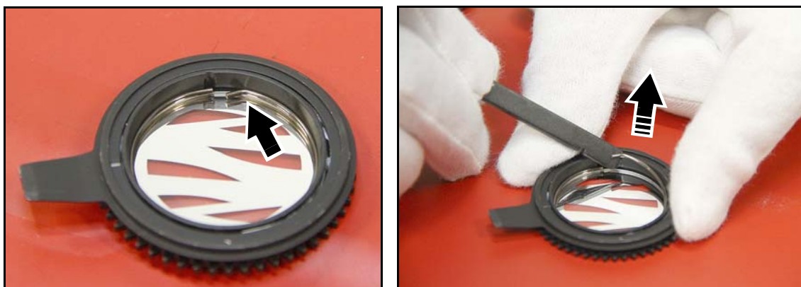
Bild 22: Entfernen eines Gobos aus dem Gobohalter
