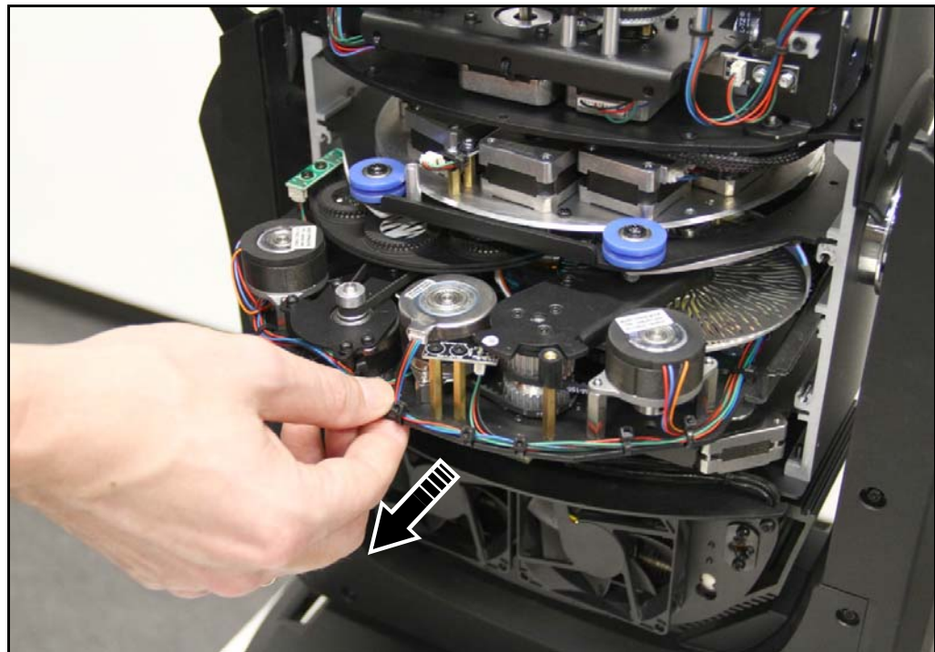
Bild 14: Entfernen des Effektmoduls
