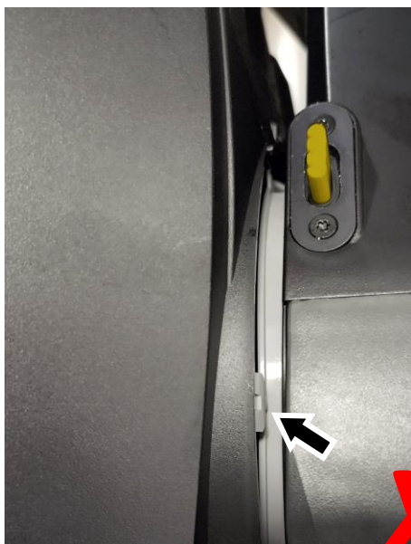
Falsch – Lasche außerhalb der Abdeckung
