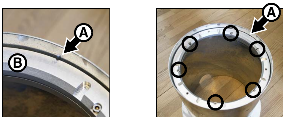
Bild 6: Markierung am Montagering
