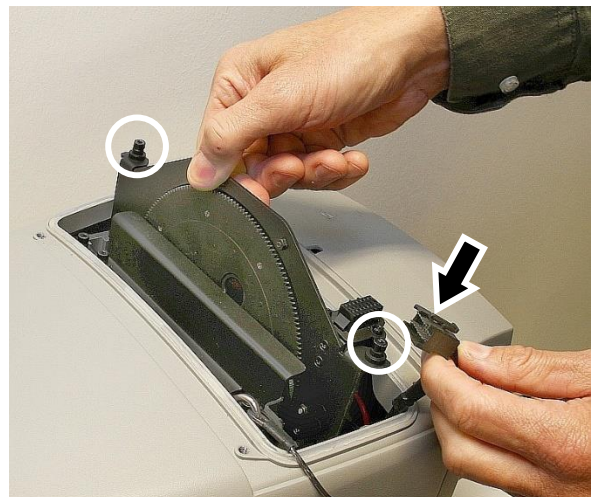
Instalación de un módulo de rueda de gobos
