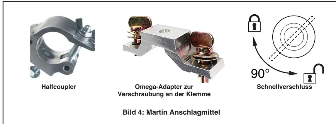
3. Siehe Bild 3 auf Seite 8. Setzen Sie die Klemme auf zwei passende Montagepunkte in der Basis des Geräts (siehe Bild 3). Führen Sie die Schnellverschlüsse ein und verriegeln Sie die Verschlüsse durch eine 90°-Drehung im Uhrzeigersinn. Installieren Sie die zweite Klemme.
