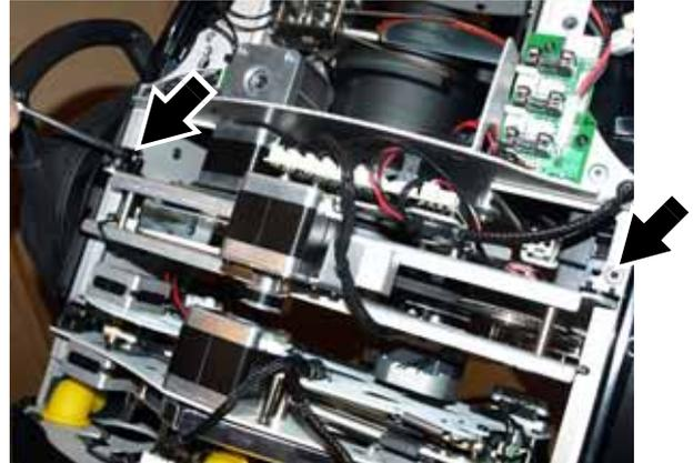
**Bild 15: Lösen der Schrauben des Projektionsmoduls**
