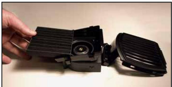
**Bild 14: Ausrichten des Filterelementes**
