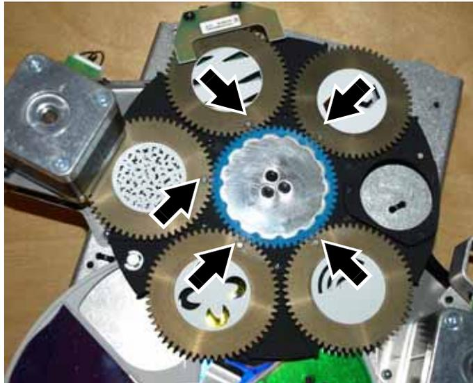
**Bild 20: Position der Gobohalter bei Austausch der Gobos**
