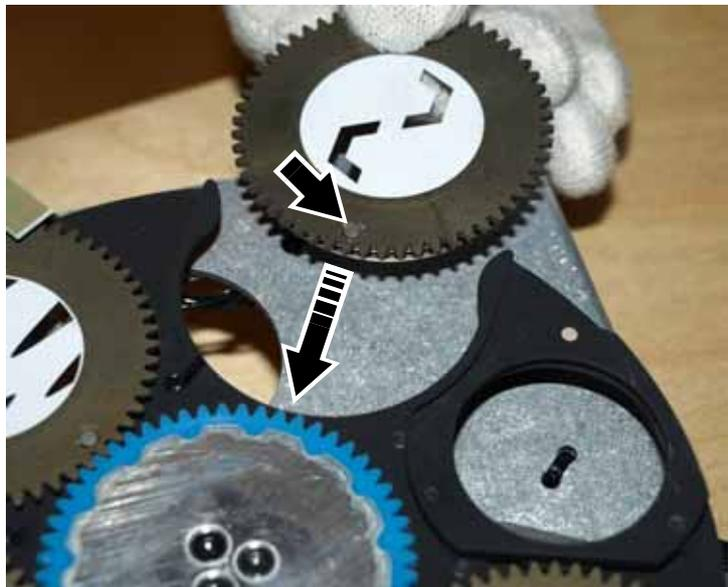
**Bild 23: Montage des Gobohalters**
