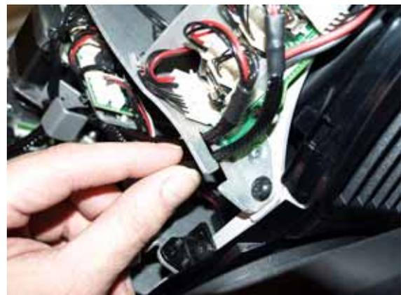
**Bild 16: Lösen der Steckverbinder des Projektionsmoduls**
