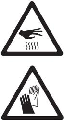
**Warnung!** Justieren Sie das Leuchtmittel bei betriebswarmen Gerät. Während der Justage ist das Gerät warm werden, tragen Sie deshalb hitzebeständige Schutzhandschuhe. Berühren Sie das Gerät nicht mit bloßer Haut, Kleidungsstücken oder anderem brennbaren Material.
