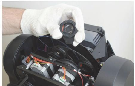
4. Das Gobo wird durch eine Feder im Halter fixiert. Entfernen Sie die Feder mit einem kleinen Schraubendreher und nehmen Sie die Feder aus dem Halter. , ersetzen Sie das Gobo, montieren Sie die Feder und den Halter im Goborad.
