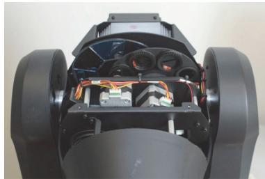
3. Die drehbaren Gobos sitzen in Haltern, die in Clips im drehbaren Goborad sitzen. Ziehen Sie den Halter des zu ersetzenden Gobos leicht vom Rad weg und aus dem Rad (siehe folgende Abbildung).
