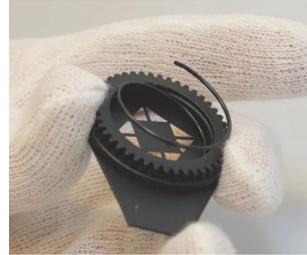
5. Gobos sind ab Werk mit etwas Klebstoff im Halter fixiert, um das Drehen des Gobos im Halter zu verhindern. Drücken Sie das Gobo aus dem Halter.
