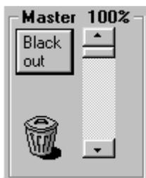
Der Master steuert den Gesamt-Ausgangspegel eines Pultes. Die „Blackout“-Taste ermöglicht außerdem jederzeit einen sofortigen Blackout aller Einheiten. Wenn Sie diese Schaltfläche erneut anklicken, wird der Master ohne Veränderung der ursprünglichen Kanalpegel wieder aktiviert.
