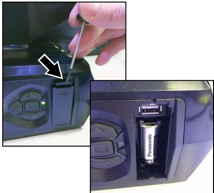
Figure 10: Compartiment de batterie
