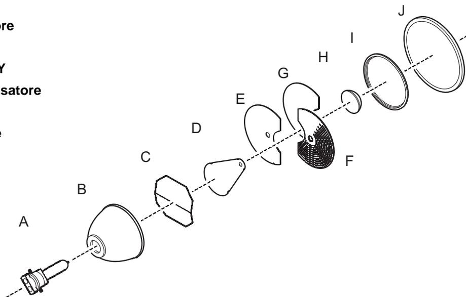
Figura 9: Struttura dell'ottica
