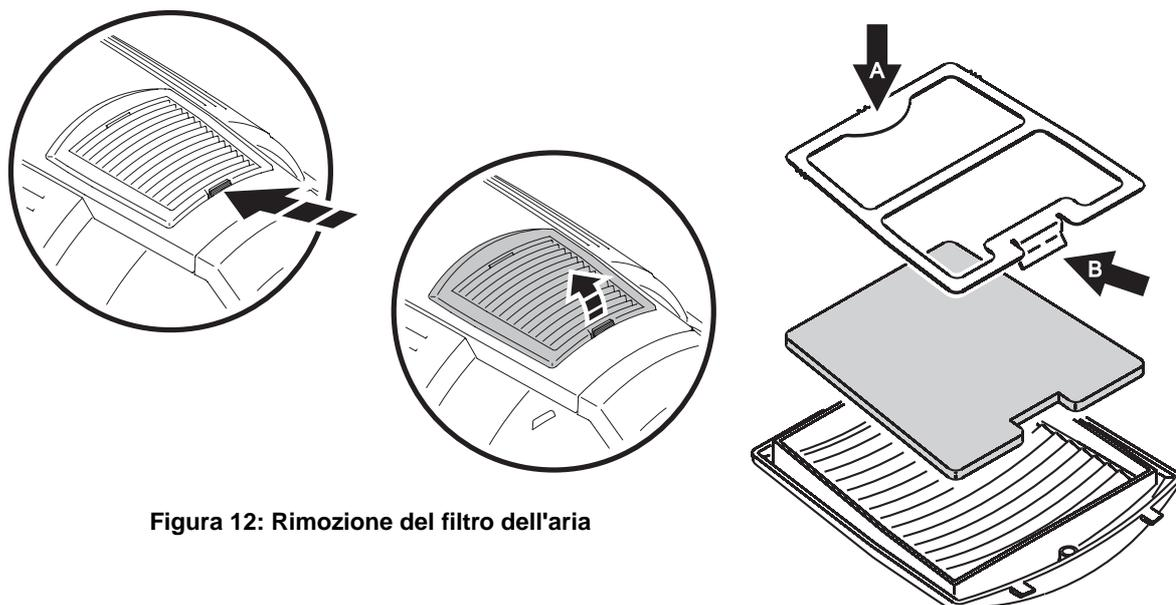
Figura 12: Rimozione del filtro dell'aria
