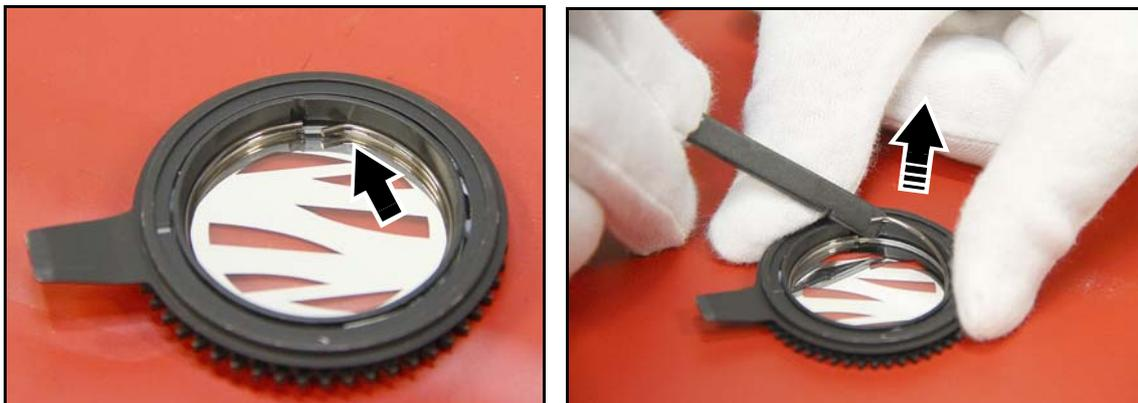
Figure 21 : retrait d'un gobo d'un support de gobo
