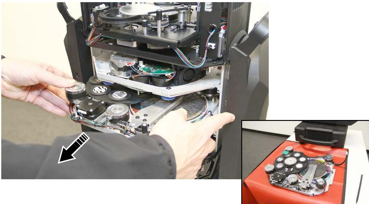
**Figure 14: Dépose du module d'effets**
