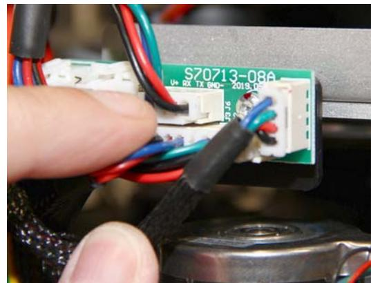
Figure 28: Reconnexion du module d'effets
