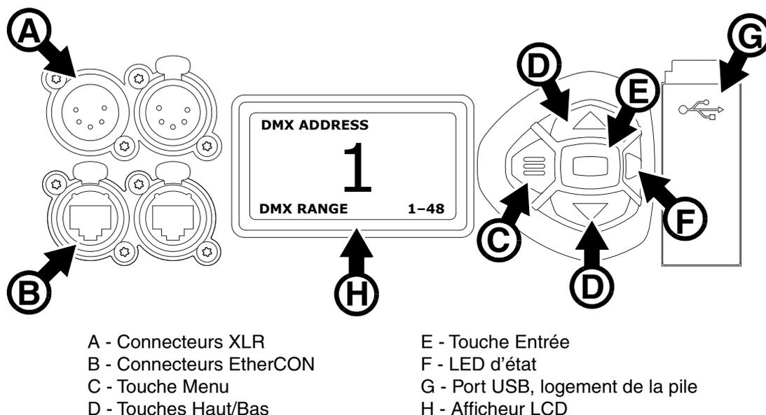
Figure 2 : Afficheur et panneau de contrôle
