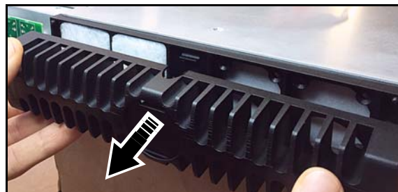
Bild 11: Zugriff auf die Luftfilter, P3-050 / P3-150
