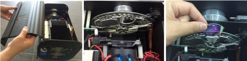
Der Glitzereffekt verfügt über ein entnehmbares Segment. Dadurch wird die volle Helligkeit in die Faser eingespeist, wenn der Glitzereffekt nicht verwendet wird. Entfernen oder installieren des Segments:
