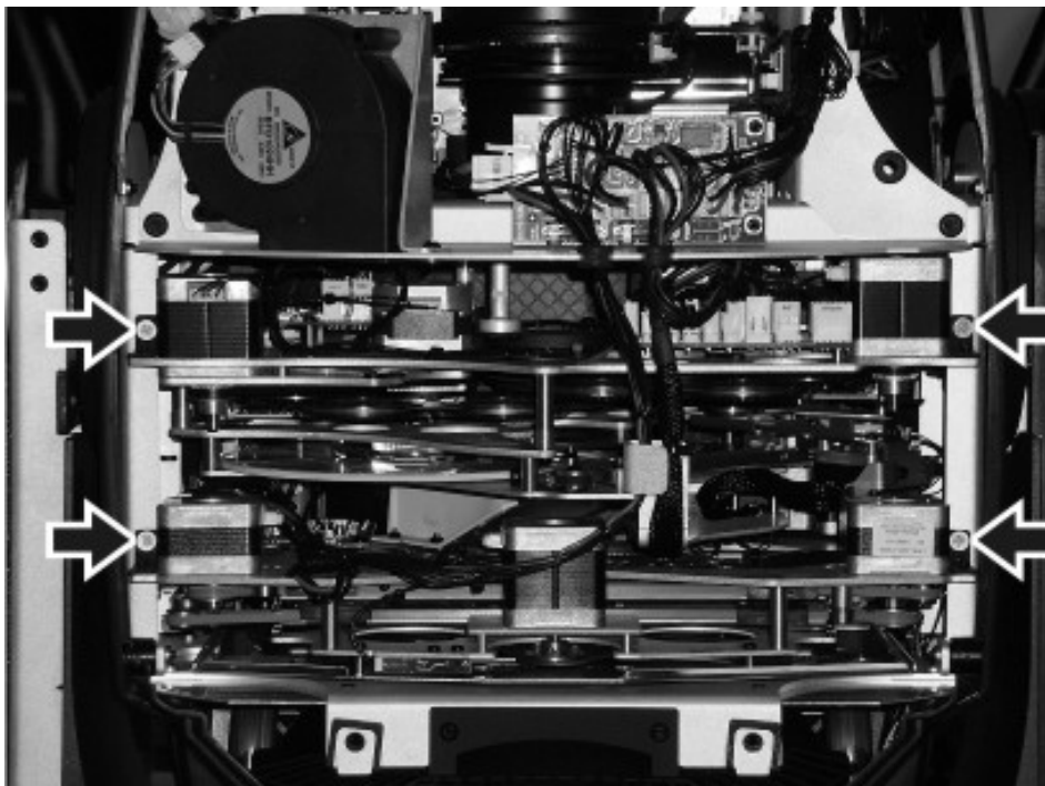
Bild 28: Befestigungsschrauben der Module
