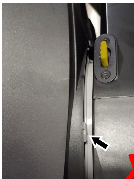
Incorrecto – pestaña fuera de la cubierta de la cabeza
