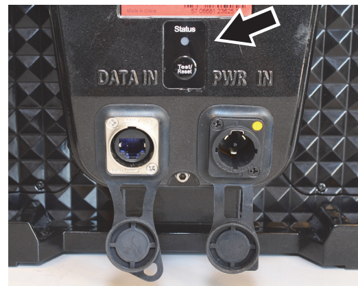
Bild 19: Test/Reset-Taste und LED Statusanzeige
