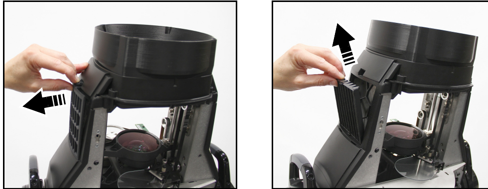
Figure 11: Dépose des filtres à air
